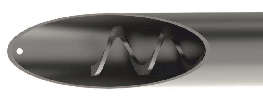
Рис.6. Монтаж спирали питателя.
