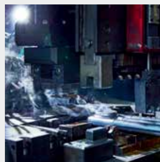
Сварка коллекторов с трубами
