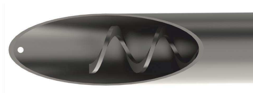
Рис. 5. Монтаж спирали питателя.
