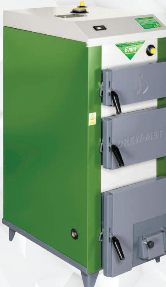
DREX - это котел на твердом топливе, сконструированный для сжигания древесины в виде поленьев. Котлы работают с использованием естественной воздушной тяги с помощью наклонного откидного клапана в дверцах зольника, который может настраиваться вручную или с помощью регулятора тяги, а процесс сжигания не требует использования электроэнергии.
