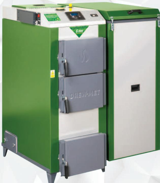
Котлы MJ-EKONOMIK являются современным оборудованием, оснащенным автоматическим чугунным устройством подачи топлива. На топке без колосниковой решетки, т.н. ретортной топке сжигается точно такая же порция угля, какая необходима для получения настроенной пользователем температуры с помощью микропроцессорного контроллера.
