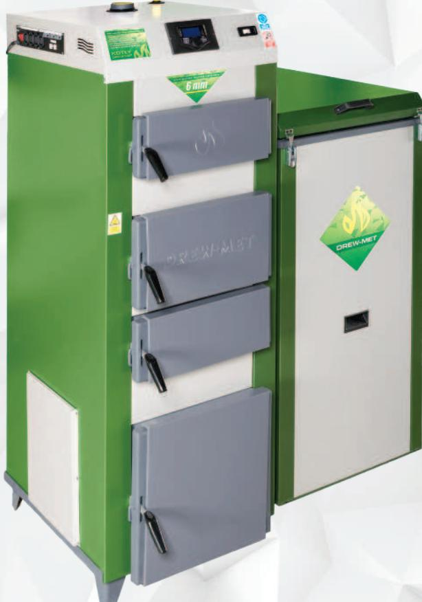
Котлы EKO-PRIM - это высокоэффективное оборудование, имеющее двойную топочную камеру. Нижняя камера, оборудованная чугунным ретортным устройством подачи, предназначена для автоматического сжигания экологичного горошкового угля. В противоположность этому, верхняя часть с водяной колосниковой решеткой дает возможность использования традиционного топлива, такого как уголь и древесина.
