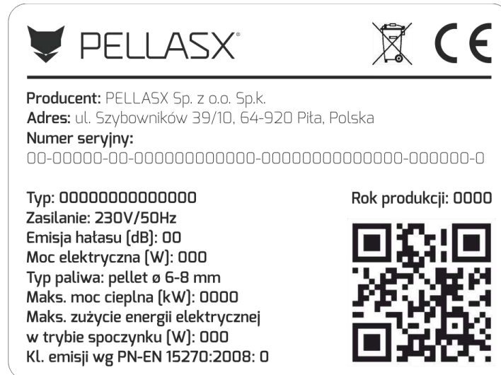
Рис. 3. Образец заводской таблички горелки.
